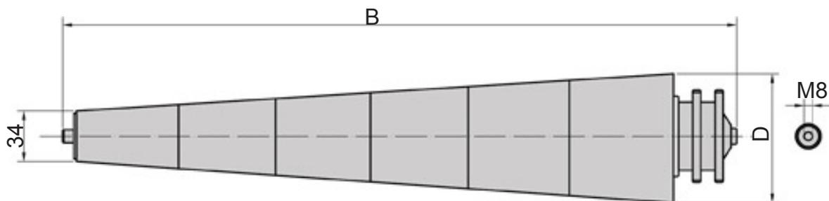
Per curve con raggio interno di 500 mm. Tubo Ø30 in acciaio, asse Ø12
